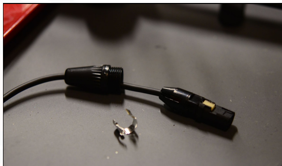
1.7 - Assembling the Mini XLR connector...
